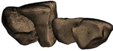
Rys. 2. Geometria mikroagregatu pokryta siatką elementów skończonych
